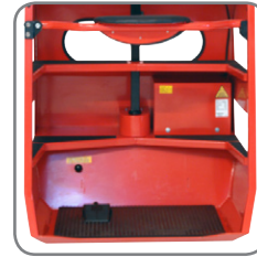
Niedrige Einstieghöhe für den Fahrer. Das Pedal dient als Totmannpedal.
