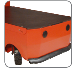
Die untere Bodengruppe ist abgeschirmt.
