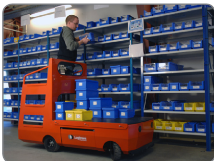
Der Logirunner beim Kommissionieren. Durch Leitersprossen schneller Aufstieg möglich.
