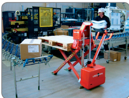
Die einstellbare Arbeitshöhe beträgt 490 - 970 mm beim Scherenhubwagen und 550 - 920 mm beim Logiflex.
