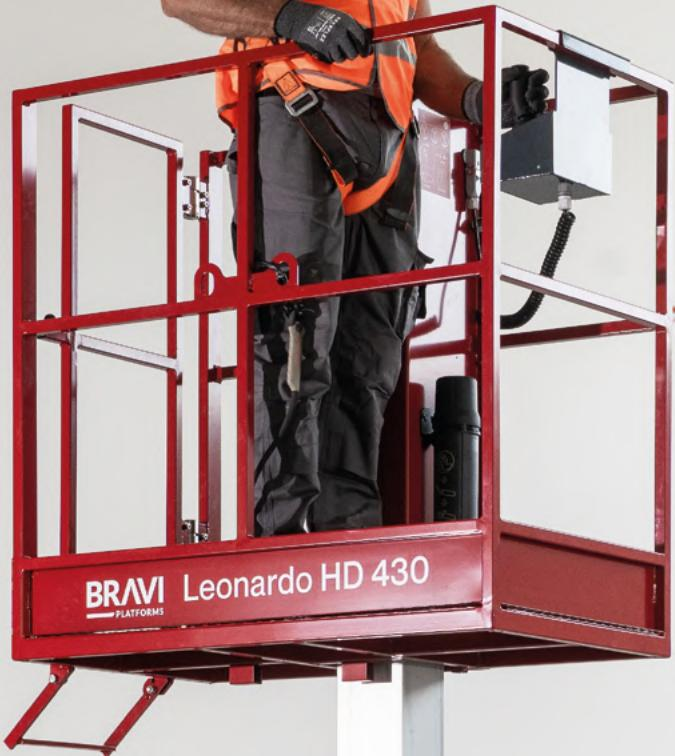
Der Leonardo HD 430 erweitert das Sortiment um eine Bühne, die dafür konzipiert wurde, größere Höhen zu erreichen (4,3 m / 14 ft 1 in Plattformhöhe / 6,3 m / 20 ft 8 in Arbeitshöhe), während die bewährten Sicherheits- und Effizienzstandards des Leonardo HD beibehalten werden. Mit einer Tragfähigkeit von 180 kg (397 lbs) und einer Breite von nur 76 cm (29,5 in) ist er eine zuverlässige Lösung für Bau-, Wartungs- und Installationsarbeiten.
