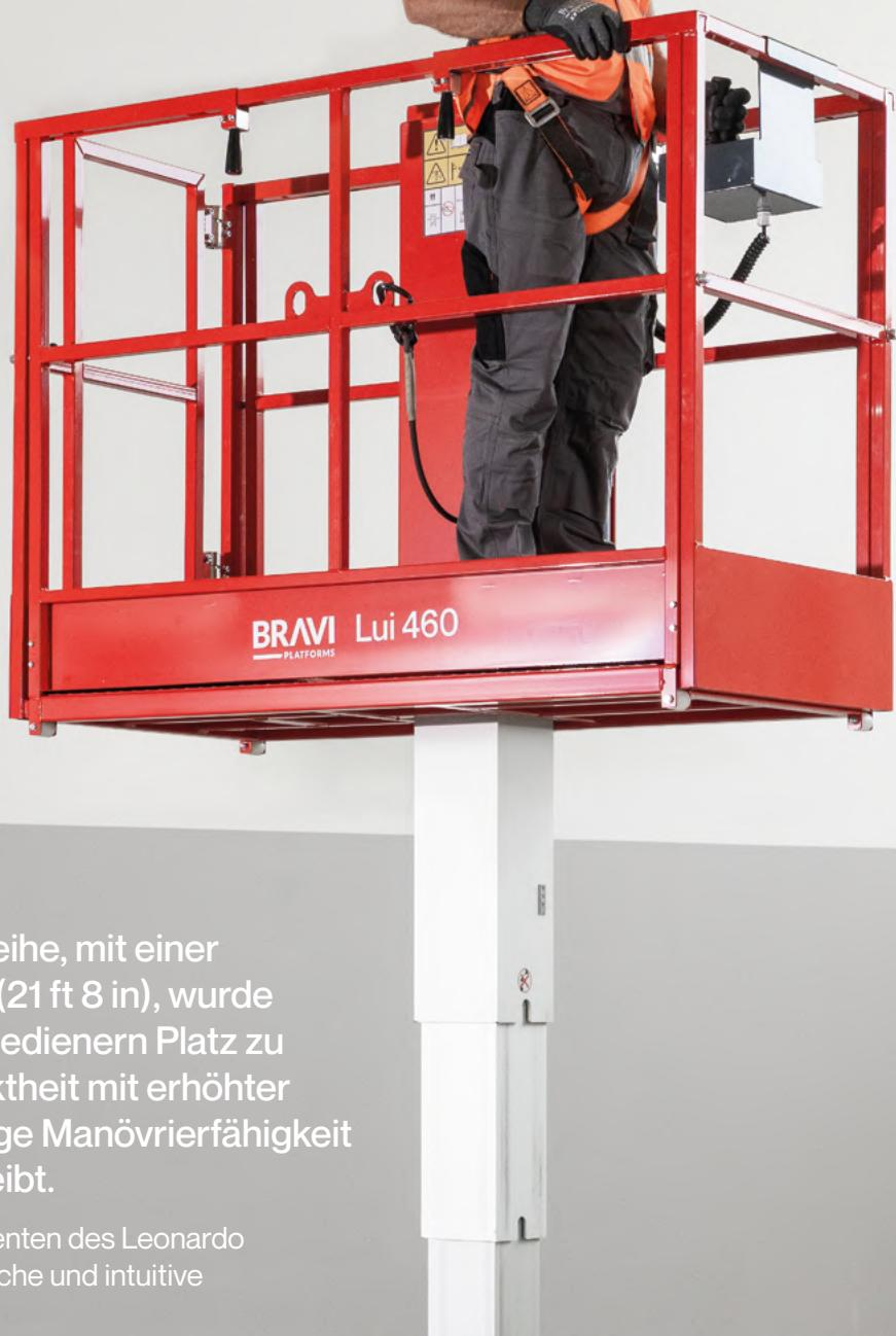
Das höchste Modell der Baureihe, mit einer Arbeitshöhe von bis zu 6,6 m (21 ft 8 in), wurde dafür konzipiert, bis zu zwei Bedienern Platz zu bieten. Es kombiniert Kompaktheit mit erhöhter Leistung, wobei die einzigartige Manövrierfähigkeit des Leonardo HD erhalten bleibt.
