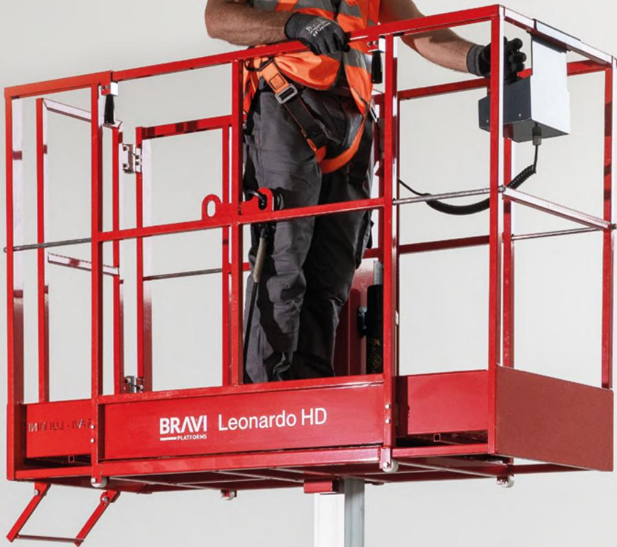
**Leonardo HD ist eine Innovation für Arbeiten in niedrige Höhe. Sie ist darauf ausgelegt, den Bediener unabhängig zu machen und ihm die Möglichkeit zu geben, eine größere Arbeitsleistung zu erbringen, indem sie die Notwendigkeit von Leitern und Gerüsten vollständig eliminiert.**
