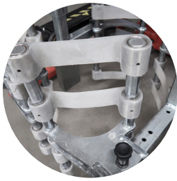
Sonder-entwickelte Greifer aus Polyurethan
